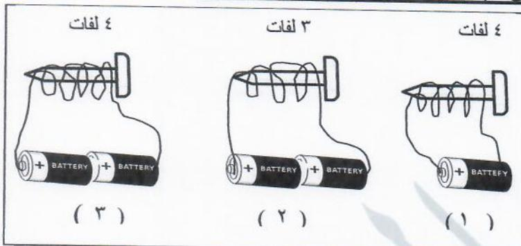
(١) الشكل المجاور يمثل المغناطيس الكهربائي
