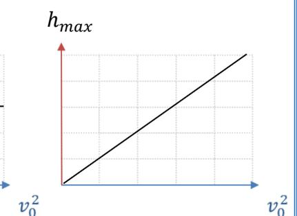
40-افضل خط بياني يمثل العلاقة بين اقصى ارتفاع للمقذوف بزاوية و السرعة الابتدائية للمقذوف بزاوية مع الأفق بثبات زاوية القذف (عند إهمال مقاومة الهواء) هو:
