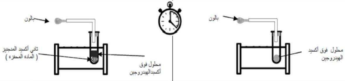
4- ضع فوق أكسيد الهيدروجين في أنبوبة إختبار كما في الشكل رقم (1) ، ثم ضع قليلاً من ثاني أكسيد المنجنيز ( المادة المحفزة ) ثم أضف عليها محلول فوق أكسيد الهيدروجين في أنبوبة الإختبار كما في الشكل رقم (2) ، ثم قارن بين الزمن المستغرق لحدوث التفاعل الكيميائي ؟
