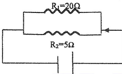
٢٤) مقاومتان  $R_1 = (20) \Omega$  و  $R_2 = (5) \Omega$  وصلتا إلى بطارية فكانت شدة التيار الكلي تساوي  $A (2)$  كما بالشكل المقابل. احسب: ص ٧٣
